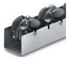
Allseiten-Rollschienen werden überall dort eingesetzt, wo flächige Gebinde, Kartons, Ladungsträger oder Werkstücke gedreht, sortiert, umgeleitet oder kommissioniert werden. Es wird empfohlen, die Allseitenrollen in die Hauptförderrichtung einzubauen, da in der Nebenförderrichtung der
