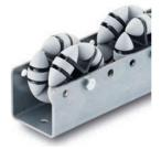
Allseitenrollschienen werden überall dort eingesetzt, wo flächige Gebinde, Kartons, Ladungsträger oder Werkstücke gedreht, sortiert, umgeleitet oder kommissioniert werden. Es wird empfohlen die Allseitenrollen, in die Hauptförderrichtung einzubauen, da in der Nebenförderrichtung der Rollwiderstand etwas größer ist. Die Abmessungen sowie das Gewicht des Fördergutes bestimmen den Rollen- bzw. Leistenabstand. Die Kräfte müssen gegebenenfalls durch Versuche ermittelt werden.
