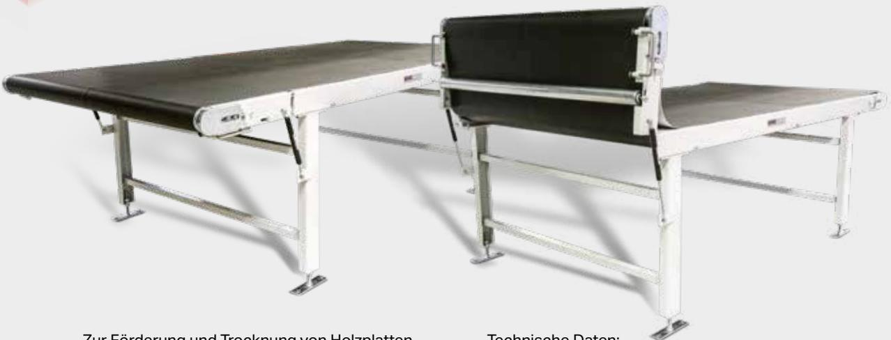
Zur Förderung und Trocknung von Holzplatten mittels UV Lampen, UV-beständiges Förderband, pneumatische Gurt-Mittelspannungseinrichtung, Steuerung über Trocknungsmaschine, einteilig hochklappbares Förderband für Servicezwecke bzw. als Durchgang, Unterkonstruktion Stahlrohr geschweißt, höhenverstellbar
